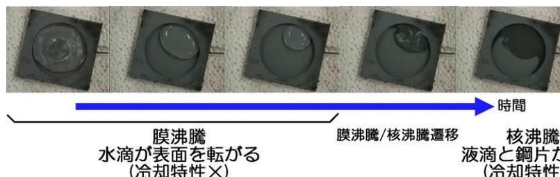
図 6 スケール付き鋼板の水冷却模擬実験: 抜熱流束を水の質量変化から測定している。
