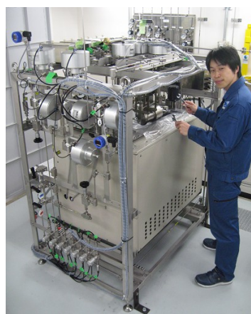
バーネット式 PVT 性質測定装置 T : 室温~250 °C, P_{\max} : 100 MPa
