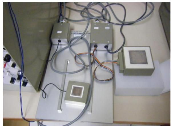
接触冷温感、熱コンダクタンスの測定
