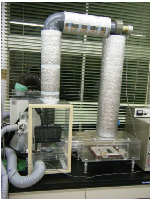
保温性を求める熱損失の測定
