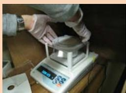
乾燥剤が吸湿した透過水蒸気量を測定（重量変化）
