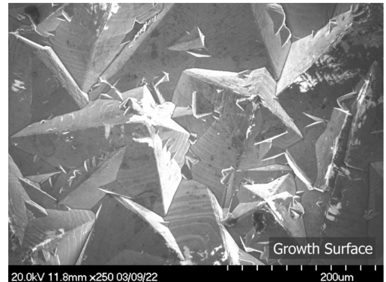
(b) CVD Diamond 結晶成長面SEM像
